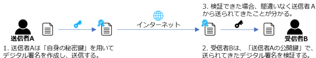
図 69. デジタル署名による送信者確認の仕組み
