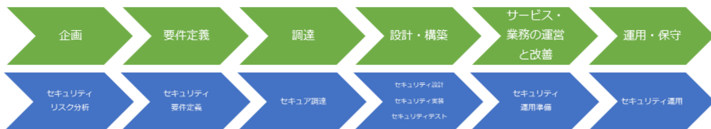
図 102. IT 導入プロセスにおけるセキュリティ対策の実施タイミング
